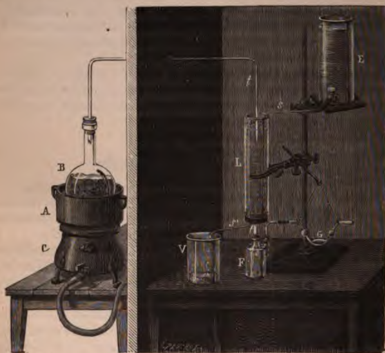
Fig. 155. — Recherche toxicologique du phosphore (méthode de Mitscherlich).
